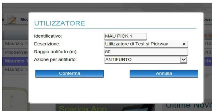
Nell'impostazione dell'immagine superiore si vede come per il PickWay, qualora venga attivato l'antifurto, il sistema controlla il punto di sosta con un raggio di 50 metri.
