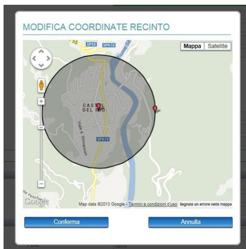
Va sottolineato che lo strumento è in grado di rilevare uno sconfinamento solamente nel momento in cui esegue un rilievo satellitare GPS. Con range di Fixing piuttosto ampi (es. 5 minuti), qualora lo sconfinamento sia di breve durata potrebbe non essere rilevato dallo strumento.
